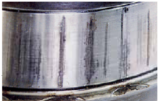
החלק: טבעת חיצונית של מיסב גלילים ספריקלי. סימפטום: מרקם גלי קמור-קעור על משטח המסילה נושא העומס. הגורם: חדירה של פסולת תוך כדי ויברציות חוזרות במצב נייח
