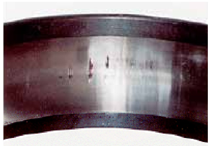
החלק: טבעת חיצונית של מיסב כדורי. סימפטום: גומות שחיקה על המסילה. הגורם: ויבראציה ממקור חיצוני במצב נייח.
