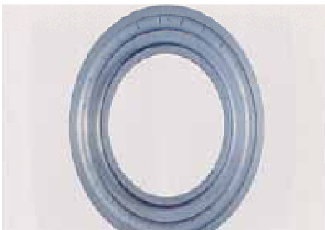
החלק: טבעת חיצונית של מיסב לחץ כדורי. סימפטום: סימני שחיקה על משטח המסילה. הגורם: ויברציות חוזרות עם זווית התנדנדות קלה.
