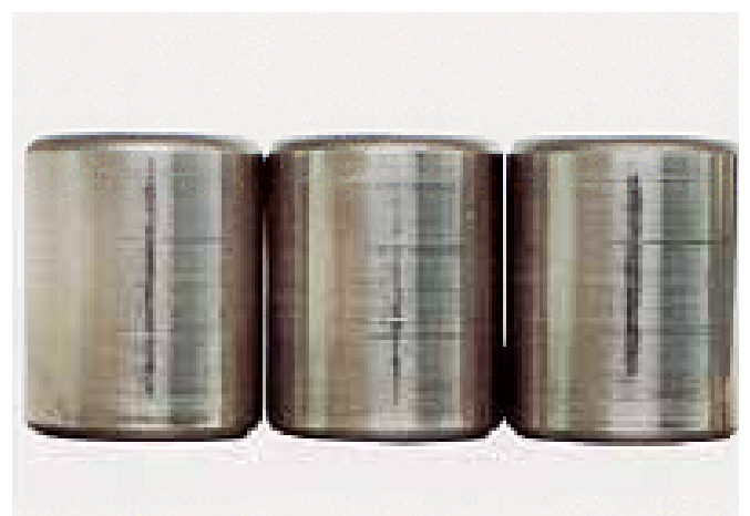
החלק: רולים של מיסב גלילים. סימפטום: סימני שחיקה על משטח הרולים. הגורם: ויבראציה ממקור חיצוני במצב נייח.
