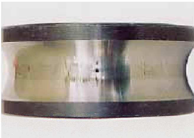
החלק: טבעת פנימית של מיסב כדורי. סימפטום: גומות שחיקה על המסילה. הגורם: ויבראציה ממקור חיצוני במצב נייח.
