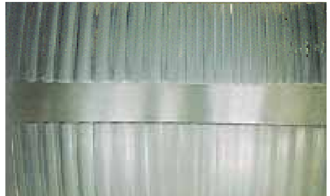
החלק: טבעת חיצונית של מיסב גלילים ספריקלי. סימפטום: מרקם גלי קמור-קעור על משטח המסילה נושא העומס. הגורם: חדירה של פסולת תוך כדי ויברציות חוזרות במצב נייח
