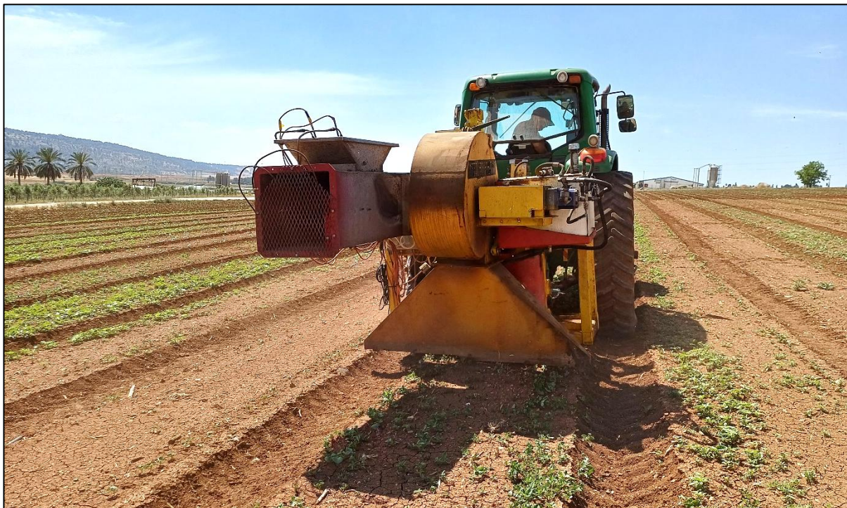
תמונה 3: מפוח החום הרתום לכלי משקי במהלך עבודה בשדה כותנה אורגנית; עין חרוד מאוחד, 2026 [צילום: ניצן כהן]
