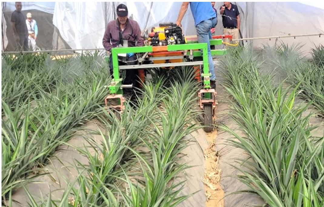
איור 6. המרסס החשמלי בפעולה בתוך מנהרה עבירה - מרסס במעבר אחד את כל שבע הערוגות
