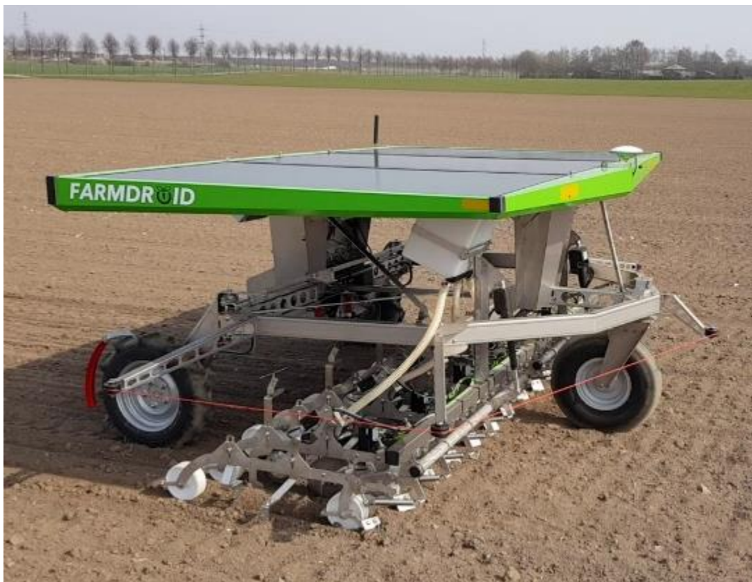
איור 1. כלי אוטונומי לזריעה ולעישוב, תוצרת Farmdroid, דגם FD20 מדנמרק
