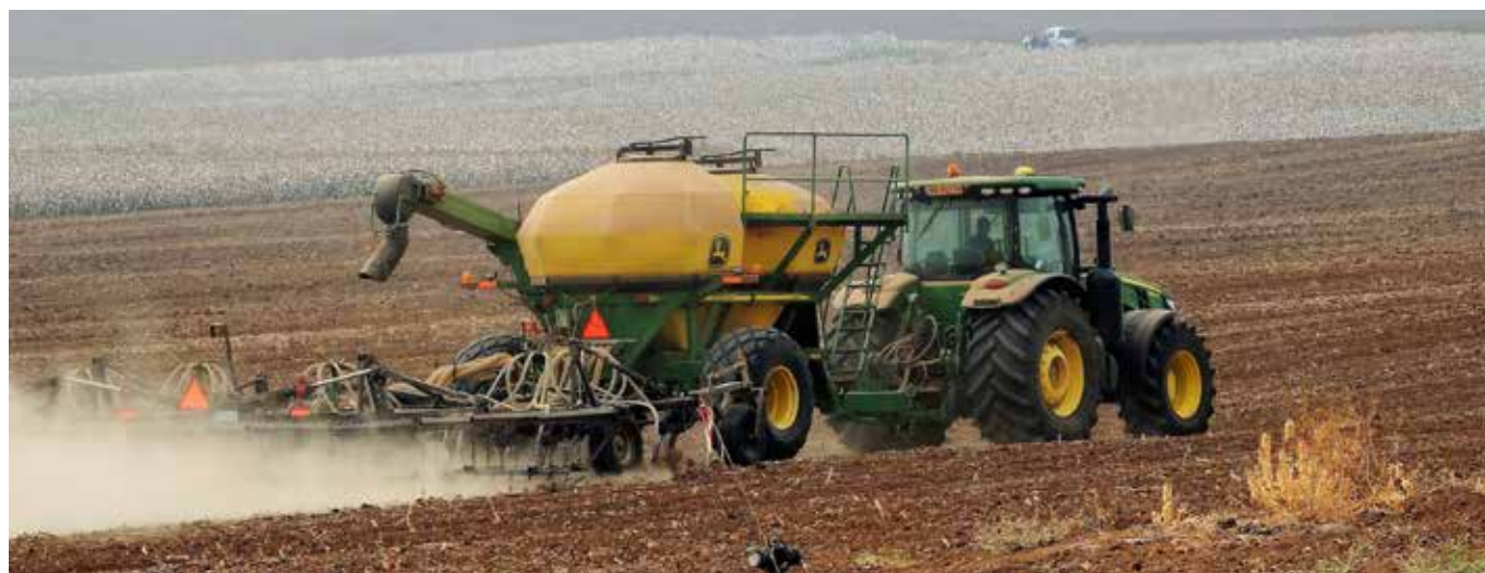
קלטרת רישון מוצק בהכנת שטחים לקראת זריעה בגד"ש עציון. צילום איתן סלע.
