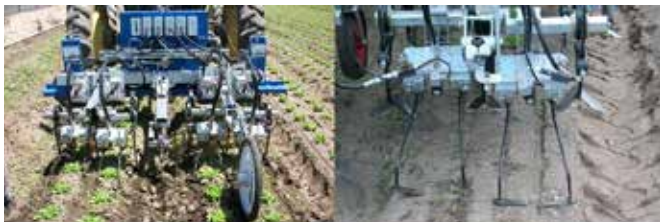
איור 1. מבט כללי על מערכת ה-Robovator (שמאל), ותמונת תקריב על הלהבים המעוקלים שמבצעים את פעולת הקלטור על פסי הזריעה (ימין).
