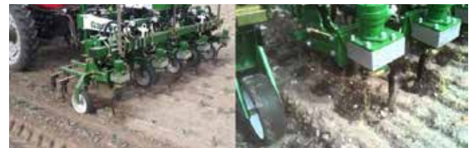
איור 1. מבט כללי על מערכת ה-Robovator (שמאל), ותמונת תקריב על הלהבים המעוקלים שמבצעים את פעולת הקלטור על פסי הזריעה (ימין).
