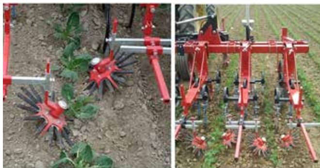
איור 3. מבט כללי על מערכת מקלטורות אצבע (ימין), ותמונת תקריב על יחידת קלטור לפס זריעה (שמאל).
