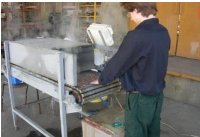
תמונה 1. מערכת לחיטוי זרעים של אגוזי אדמה
