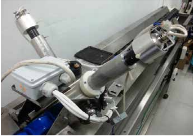
תמונה 4: מערכת מיקוד תאורה על גבי מדגים מיון תמרים
