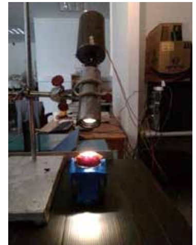
תמונה 3: אב טיפוס למערכת עדשות למיקוד תאורה על תמר
