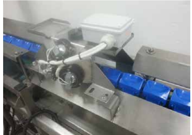
תמונה 2: תא תאורה עם 6 נורות הלוגן לכיסוי מקיף במדגים בתמרים
