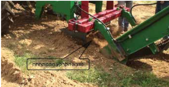
תמונה 1. מתחחה מסתובבת לאחור ומשליכה קרקע על מסוע
