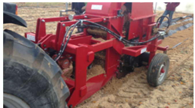
תמונה 4. המכונה בייצור תעלות מדופנות ביריעות במבט מלפנים
