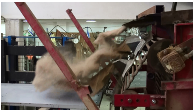
תמונה 2. מסוע שקתות אנכי מסיע קרקע למשטח אופקי שמדמה מסוע
