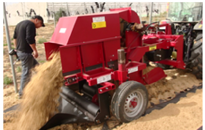
תמונה 5. המכונה בייצור תעלות מדופנות ביריעות במבט מאחור
