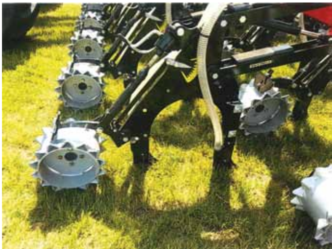
מזרעה תוצרת Dale drills אנגליה כמזרעה מיכל מחולק לזרעים ורשן, הצנעה נפרדת של הזרעים והרשן זה לצד זה, ברגליים נפרדות, ניתן לכוון עומק של כל יחידה בנפרד. המזרעה מצוידת באבטחה חנקנית.
