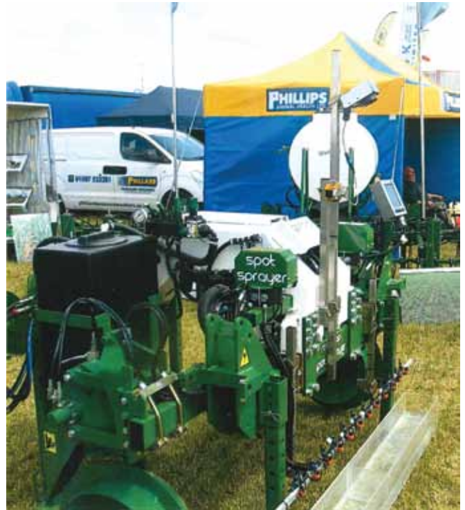
מערכת ריסוס תוצרת Garford אנגליה (המערכת זכתה בפרס בשנת 2014) מוט ריסוס עם פומיות צפופות, מצלמה ובפיקוד חשמלי נפרד לכל פומית.
