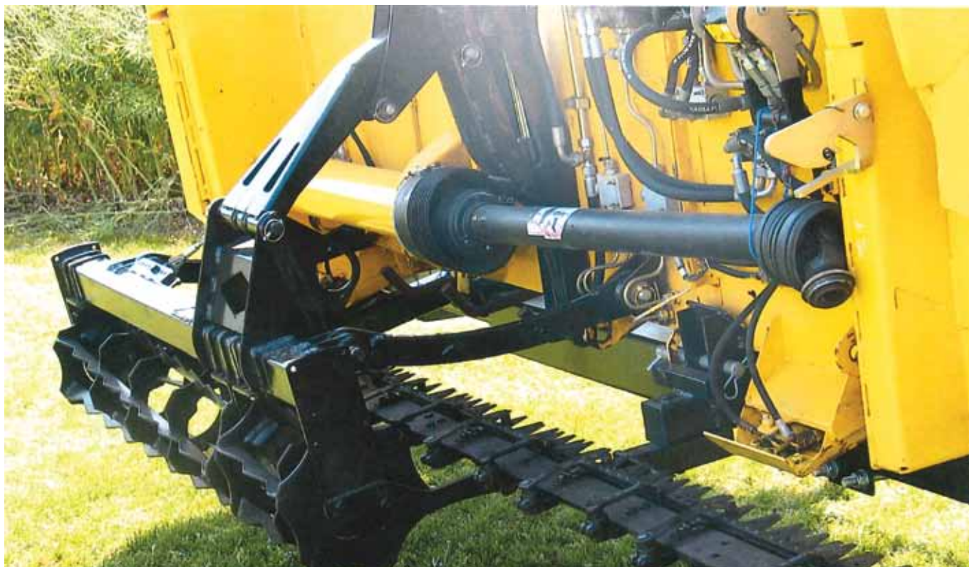
תוספת מקצרה לקומביין תבואות. כדי להפחית את עומס הקש על מערכת ההפרדה, פיתחה חברת ניו הולנד מקצרה נוספת לשולחן הקצירה. התוספת כוללת סכין, שמאפשר קצירה נמוכה של הקש, קרוב לקרקע, אחרי הקצירה הגבוהה של השיבולים, שנעשית על ידי השולחן המקורי.
