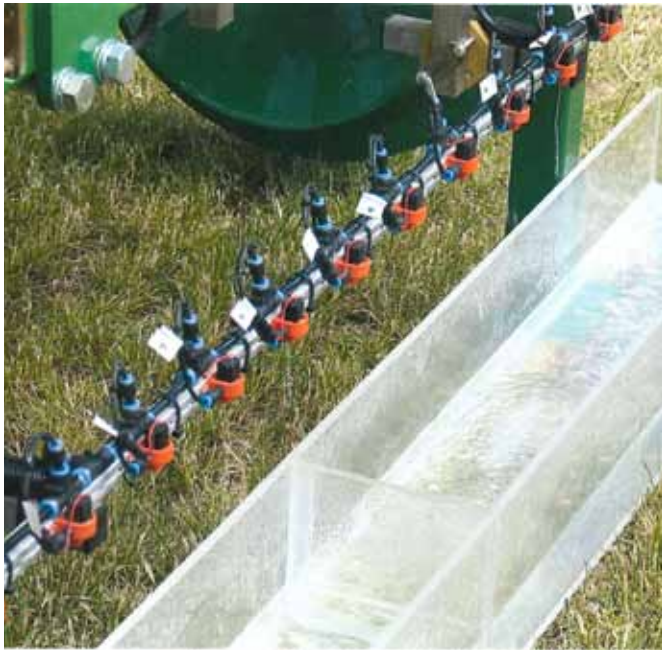
מערכת ריסוס תוצרת Garford אנגליה (המערכת זכתה בפרס בשנת 2014) מוט ריסוס עם פומיות צפופות, מצלמה ובפיקוד חשמלי נפרד לכל פומית.
