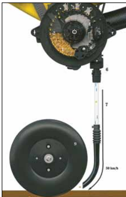
מנגנון הזריעה הזרעים נצמדים לצלחת ומועפים לצינור הזריעה כלחץ אוויר.
