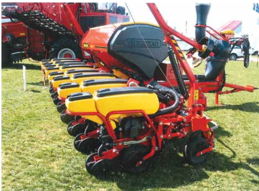
מזרעת Tempo מתוצרת Vaderstad שוודיה בעלת שני מכלים נפרדים לזרעים ולדשן. במזרעה זו יש הפעלה חשמלית נפרדת לכל יחידת זריעה, עם שליטה מתא הנהג. הצג מראה דיילוגים, כפולים, מרחקים וזרעים ליחידת שטח. יש גם אופציה להפעלה מאיפס.
