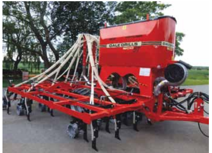
מזרעה תוצרת Dale drills אנגליה כמזרעה מיכל מחולק לזרעים ורשן, הצנעה נפרדת של הזרעים והרשן זה לצד זה, ברגליים נפרדות, ניתן לכוון עומק של כל יחידה בנפרד. המזרעה מצוידת באבטחה חנקנית.
