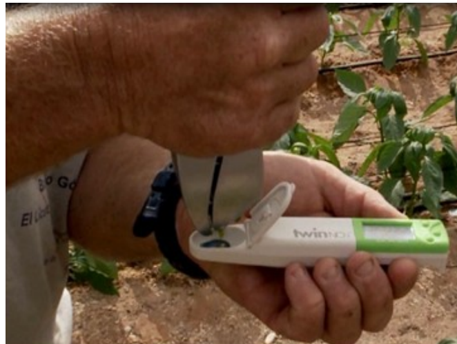
תמונה 1 : סחיטת פטוטרת טריות בשדה באמצעות כותש שום ומדידה באמצעות מכשיר מסוג Horiba NO 3 meter.
