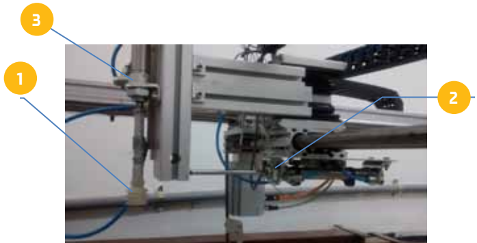
איור 3 - מערכת מופעלת פניאומטית. (1) תפסנית ואקום, (2) בוכנה פניאומטית לתנועה אופקית (3) בוכנה פניאומטית לתנועה מעלה/מטה.
