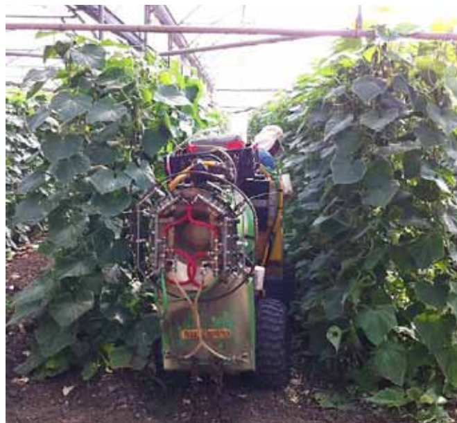
ציר 4 - מערכת ריסוס אלקטרוסטטית מותקנת על מרסס צ'יקו לחממת עגבניות ומלפפון.
