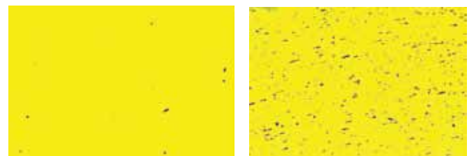
ציור 5 – הרבצת טיפות על ניירות רגישים למים אשר הודבקו בצדו האחורי של גליל, בניסוי של התותח ללא טעינה חשמלית (משמאל) ובניסוי נוסף זהה לקודם אך עם טעינה חשמלית (מימין).
