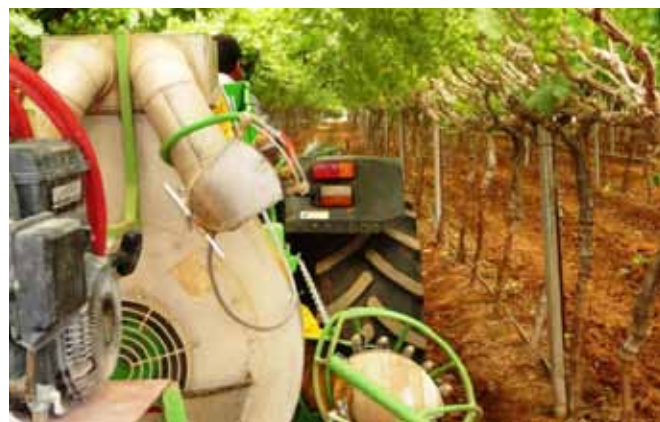
ציור 3 – מרסס כרם מסחרי עליו מותקן התקן לטעינת השראה והמרסס פועל עם פומיות הידראוליות קונבנציונליות (מימין). התקן של אלקטרודות לטעינת השראה על כף לריסוס כרם, כשעל הכף מותקנות פומיות הידראוליות קונבנציונליות, המבודדים עוברים ייבוש מתמיד ועליהם מותקנות האלקטרודות (משמאל).
