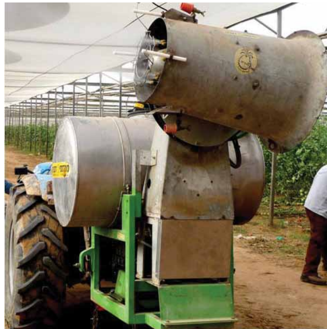
ציור 2 – התקן לטעינה אלקטרוסטטית של התרסיס מותקן על מרסס תותח. המרסס מוסע על גבי טרקטור בחממת עגבניות בניצב לשורות.
