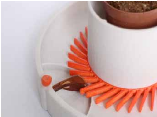
אובייקט מספר 1 - מנגנון סיבובי מונע על ידי קשקש של איצטרובל.
