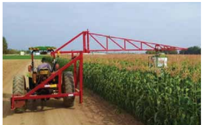
איור 5 - עבודת אבהטיפוס המשופר, כאשר הוא מותקן על טרקטור סטנדרטי. מראה כללי (מימין) ומבט על תנועת ראש האיסוף בשדה (משמאל).
