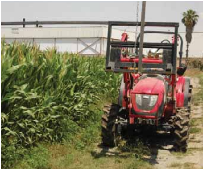
איור 4 - ראש האיסוף מותקן על טרקטור בעל מזלג קדמי, הנוסע לצד השדה ונושא את ראש האיסוף בתוך השדה, לאורך שורה קרובה לשוליים.
