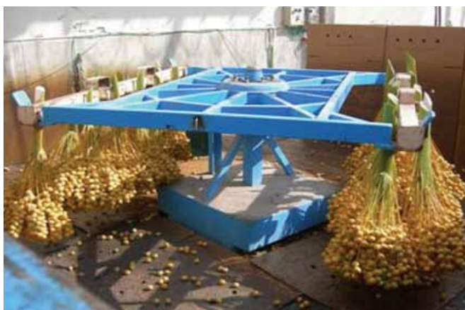
איור 1: מערכת ה"צנטריפוגה" המבוססת על חימום בקוטר של כ-2 מ' שעליו תלויים האשכולות על קורות תליה שכל אחת מהן מסוגלת לשאת 11 אשכולות
