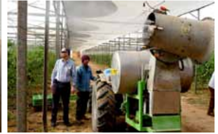
איור 2: התקן לטעינה אלקטרוסטטית של התרסיס מותקן על מרסס תותח בחממת עגבניות, הריסוס בניצב לשורות.
