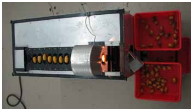
איור 1: מערכת מיון לשלוש קבוצות הפועלת בתנועה רציפה עם תא תאורה ומערכת משפך סוכר
