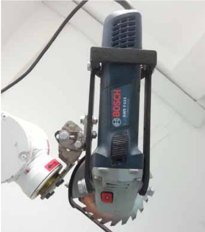
איור 7: משור מחובר למנוע מורכב עם מתאם לזרוע רובוט.
