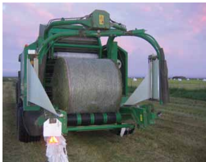
תמונה 4 - חבילה קשורה ברשת לפני העטיפה ביריעת פלסטיק.
