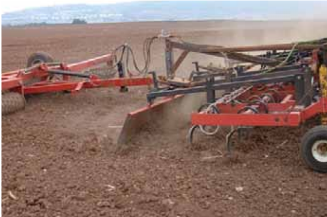
הצנעת אמוניה מימית בקלטור כפלחה. יתרונות: חיסכון בהילוכים, דיוק והצנעה מיידית-מניעת איבודים וחסכון, שימוש ברשן זול ויעיל בכמויות מופחתות.
