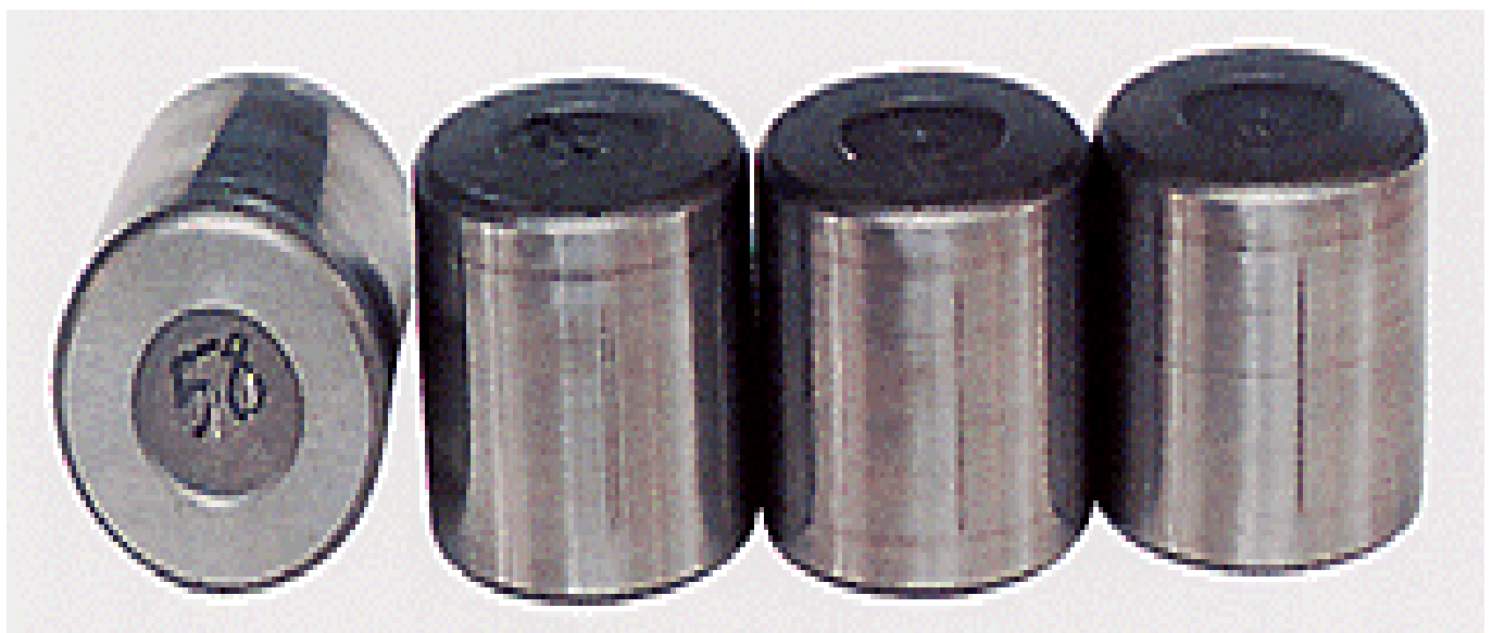
החלק: גלילים (רולים) של מיסב גלילים. סימפטום: שריטות ציריות על משטח הגלילים. הגורם: הטיה של הטבעת החיצונית והפנימית במהלך ההרכבה.
