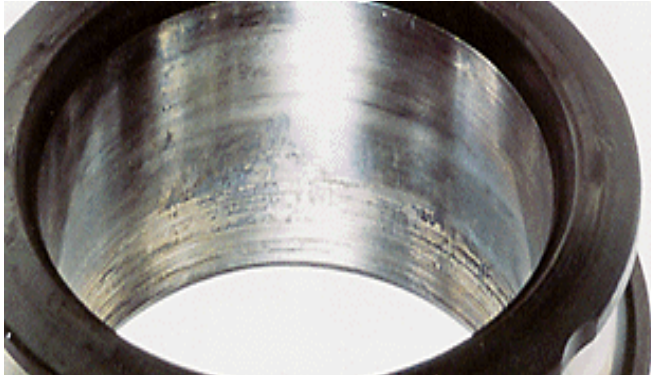
החלק: טבעת פנימית של מיסב גלילים ספריקלי. סימפטום: זחילה המלווה בחריצת משטח הציר הגורם: בלימה בלתי מספקת
