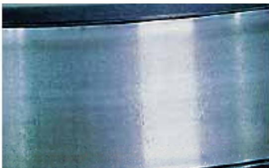
החלק: טבעת פנימית של מיסב גלילים קוני. סימפטום: חריצים / שינונים קטנים וגדולים מופיעים על פני כל משטח המסילה. הגורם: רסיסים אשר נתפסו במשטח.
