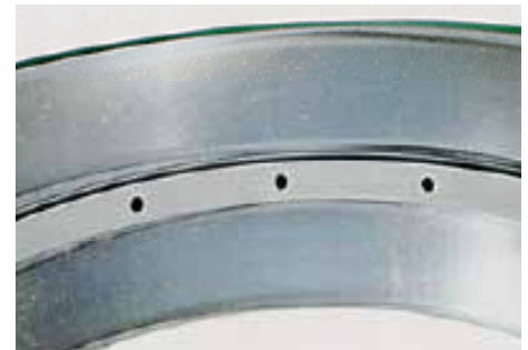
החלק: טבעת חיצינית של מיסב גלילים קוני בעל שורה כפולה. סימפטום: חריצה במשטח המסילה. הגורם: רסיסים אשר נתפסו במשטח.
