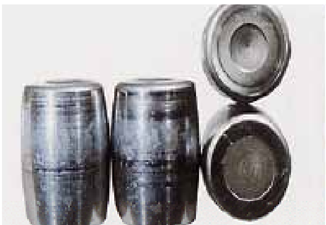
החלק: גלילים / רולר קמור סימפטום: אזורי התקלפות עגלגלים על מרכז משטחי הגלילים. הגורם: גירוז בלתי מספיק
