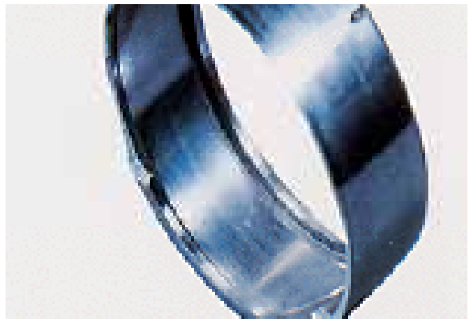
החלק: טבעת חיצונית של מיסב מחטים. שבר בצלע הטבעת החיצונית. הגורם: נטייה של הגליל כתוצאה מעומס יתר. (מיסבי מחטים הינם ארוכים בהשוואה לקוטרם. תחת עומס יתר או פיזור לא שווה של העומס, נוצרת נטייה/שיפוע בגלילים אשר נדחקים כנגד הצלעות)
