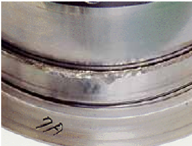
החלק: טבעת פנימית של מיסב גלילים בעל שורה כפולה סימפטום: שבר של מרכז הצלע. הגורם: עומס יתר בעת ההרכבה
