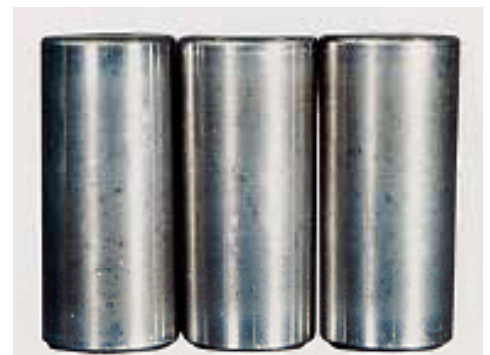
החלק: גלילים של מיסב קוני. סימפטום: חריצים / שינונים קטנים וגדולים מופיעים על פני משטח הגלילים. הגורם: רסיסים אשר נתפסו במשטח.
