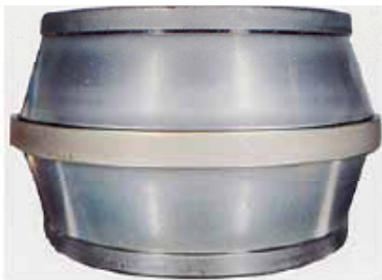
החלק: טבעת פנימית של מיסב גלילים קוני בעל שורה כפולה. סימפטום: משטח המסילה מזוגג (מעומם). הגורם: רסיסים הנתפסים במשטח.
