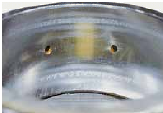
החלק: טבעת חיצונית של מיסב גלילים ספריקלי סימפטום: התקלפות באזור כתף המסילה לאורך מלוא ההיקף. הגורם: גירוז בלתי מספיק
