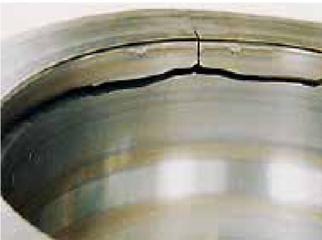
החלק: טבעת חיצונית של מיסב גלילים בעל שורה כפולה. סימפטום: סדקים המתפשטים כלפי חוץ בכיוון הציר וההיקף, ממקור ההתפוררות במשטח המסילה. הגורם: התפוררות עקב פגם כתוצאה מזעזוע
