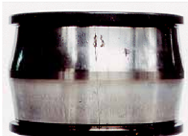
החלק: טבעת פנימית של מיסב גלילים ספריקלי. סימפטום: סדקים ציריים על פני-שטח המסילה. הגורם: לחץ התאמה רב שנוצר בעקבות הבדלי טמפרטורה בין המוט והטבעת הפנימית.
