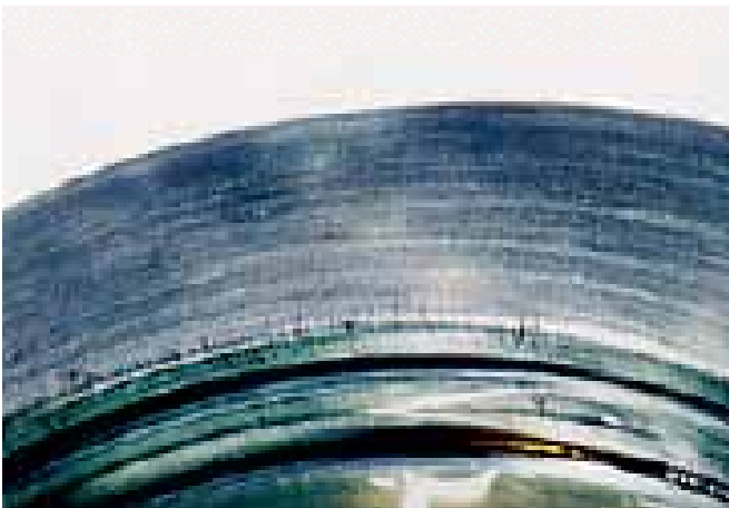
החלק: טבעת פנימית של מיסב גלילים ספריקלי סימפטום: אזורי התקלפות עגלגלים הגורם: גירוז בלתי מספיק
