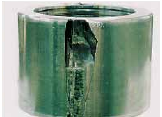
החלק: טבעת חיצונית של מיסב גלילים בעל שורה כפולה, משמש לסיבוב טבעת חיצונית. סימפטום: סדקים במשטח החיצוני. הגורם: שחיקה משוטחת והיווצרות חום כתוצאה מחוסר סיבוב הטבעת החיצונית.
