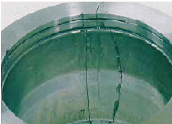
החלק: משטח מסילה של טבעת חיצונית בתמונה 4-6 סימפטום: התפשטות של סדקים מהמשטח החיצוני למסילה
