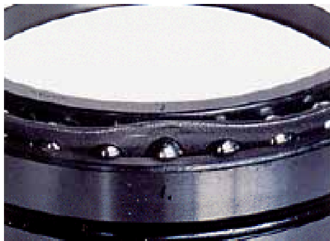
החלק: כלוב של מיסב כדורי חצי-לחץ. סימפטום: עיוות של כלוב הפלדה. הגורם: זעזועי עומס כתוצאה מטיפול בלתי הולם.
