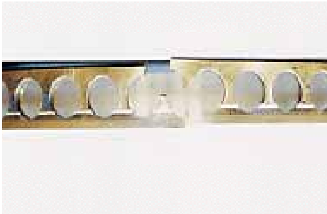
החלק: כלוב של מיסב כדורי חצי-לחץ. סימפטום: שבר של כלוב הפליז / ברונזה (מיוצר מכאנית במתיחה חזקה).
