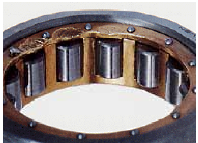
החלק: כלוב של מיסב גלילים. סימפטום: עיוות של פני הצד כלוב הפליז / ברונזה (מיוצר מכאנית במתיחה חזקה). הגורם: זעזוע רב בעת ההרכבה.
