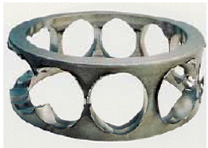
החלק: כלוב של מיסב כדורי חצי-לחץ. סימפטום: שבירת עמודי הכיס של כלוב ברזל יצוק. הגורם: הפעלה חריגה של עומס על הכלוב כתוצאה מחוסר יישור בין הטבעת החיצונית לפנימית בעת הרכבת המיסב.
