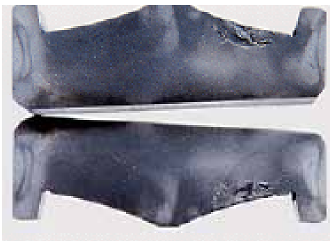
החלק: חתך רוחב של טבעת פנימיתסדוקה, סימפטום: המקור נמצא ישירות מתחת לפני-שטח המסילה
