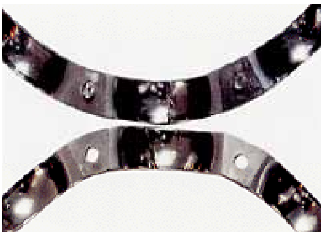
החלק: כלוב של מיסב כדורי. סימפטום: שבר בכיס כלוב הפלדה.
