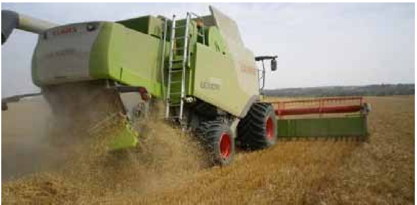
מפזר מוץ - מורכב על קומביין קלאס: רוחב פיזור מעל 4 מטר, במקום שיהיה מרוכז בפחות מ 2 מטר.
