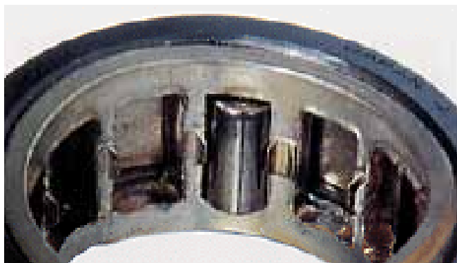
החלק: כלוב של מיסב גלילים. סימפטום: עיוות ובלאי של כלוב הפליז / ברונזה (מיוצר מכאנית במתיחה חזקה).
