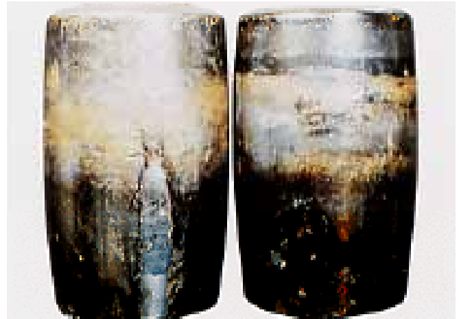
החלק: רולר קמור סימפטום: דהייה והמסה של משטח הרולים, הדבקות של חלקיקים בלויים מכלוב המיסב. הגורם: גירוז בלתי מספיק.
