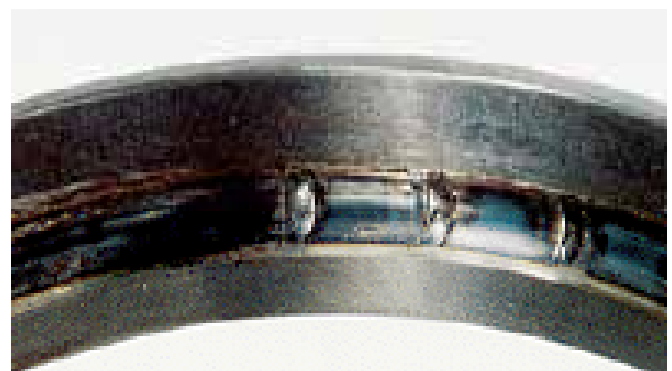
החלק: טבעת חיצונית סימפטום: טבעת המיסב דהויה, המסה מתרחשת באזורי מרווחי הכדורים. הגורם: קדם-עומס יתר.
