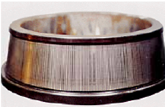
החלק: טבעת פנימית של מיסב קוני. סימפטום: קורוזיה (שיתוך) בצורת פסים מתרחשת על פני משטח המסילה.
