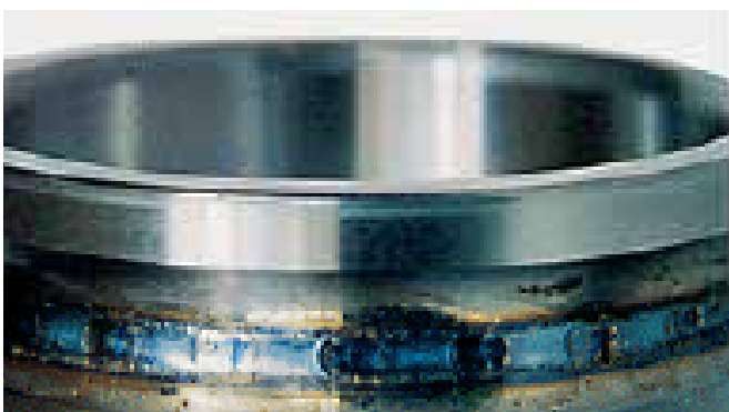
החלק: טבעת פנימית של מיסב כדורי חצי-לחץ. סימפטום: טבעת המיסב דהויה, המסה מתרחשת באזורי מרווחי הכדורים. הגורם: קדם-עומס יתר.
