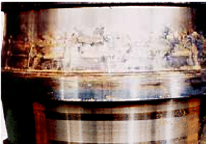
החלק: טבעת פנימית של מיסב גלילים ספריקלי. סימפטום: טבעת דהויה עם סימני התכה. חלקיקים בלויים מכלוב המיסב נדבקו למסילה. הגורם: גירוז בלתי מספיק.
