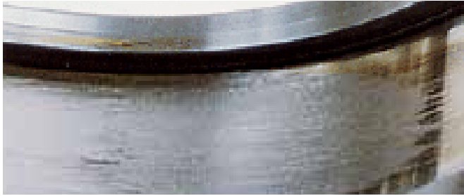
החלק: טבעת חיצונית של סימפטום: מריחה סביב היקף משטח המסילה הגורם: החלקה של הגלילים בגלל שימוש בכמות מוגזמת של גריז
