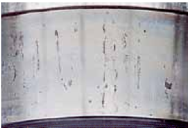
החלק: החלק: טבעת פנימית של מיסב גלילים ספריקלי. סימפטום: חלודה על משטח המסילה במיקום מרווחי הרולים. הגורם: חדירה של מים לתוך הגריז
