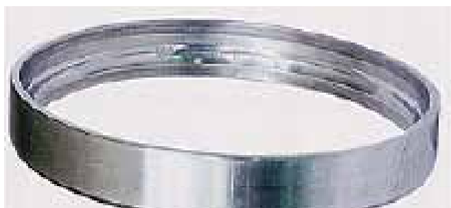
החלק: טבעת חיצונית של מיסב כדורי חצי-לחץ. סימפטום: התפוררות של המסילה במיקום בו נמצאים הכדורים. הגורם: פגיעה כתוצאה מזעזועי עומס במצב נייח.
