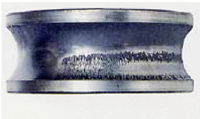
החלק: טבעת פנימית של מיסב כדורי זוויתי חצי לחץ. סימפטום: התפוררות בחצי מהיקף משטח המסילה. הגורם: גירוז לא מספיק כתוצאה מחדירת נוזל צינן לתוך המיסב.
