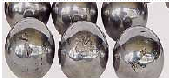
החלק: כדורים של מיסב כדורי חצי-לחץ. סימפטום: התפוררות של משטח הכדור. הגורם: פגיעה כתוצאה מזעזועי עומס במצב נייח.
