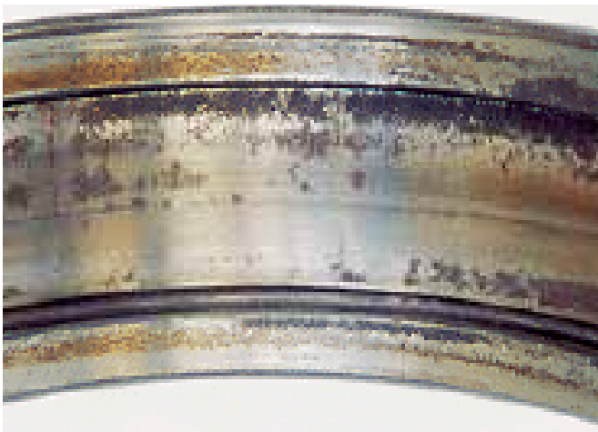
החלק: טבעת חיצונית של מיסב גלילים. סימפטום: חלודה על פני הצלע ומשטח המסילה. הגורם: חדירה של מים.
