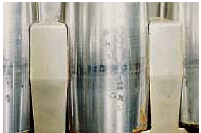
החלק: גלילים (רולים) של מיסב גלילים. סימפטום: חלודה בצורת גומות על משטח המגע של הרולים. חלק מאוכל. הגורם: התעבות לחות בזמן אחסנת המיסב.
