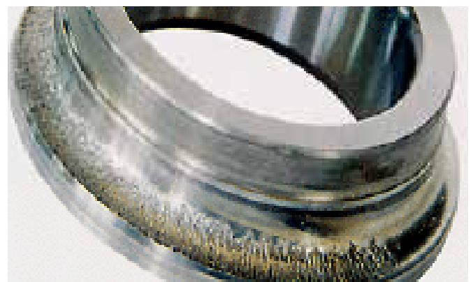
החלק: טבעת פנימית של מיסב כדורי זוויתי חצי לחץ. סימפטום: התפוררות אלכסונית לאורך המסילה. הגורם: חוסר יישור בין המוט והבית במהלך ההרכבה.
