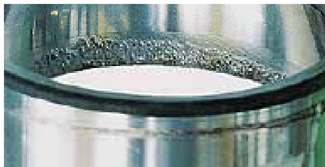
החלק: טבעת חיצונית של סימפטום: התפוררות של מסילה אחת בלבד לאורך כל היקפה. הגורם: עומס צירי עודף
